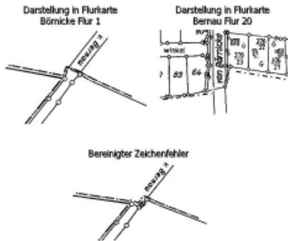
Abb. 5: Unterschiedliche Darstellungen gleicher Grenzverläufe in zwei Flurkarten
