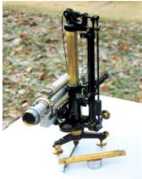
Abb. 3: Das von Prof. Vogler entwickelte Schiebekathetometer
