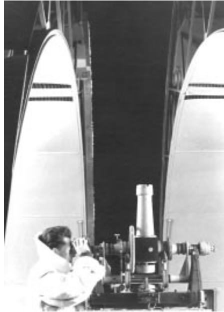
Abb. 4 Astronomische Zeitbestimmung mit Askania-Meridianinstrument
