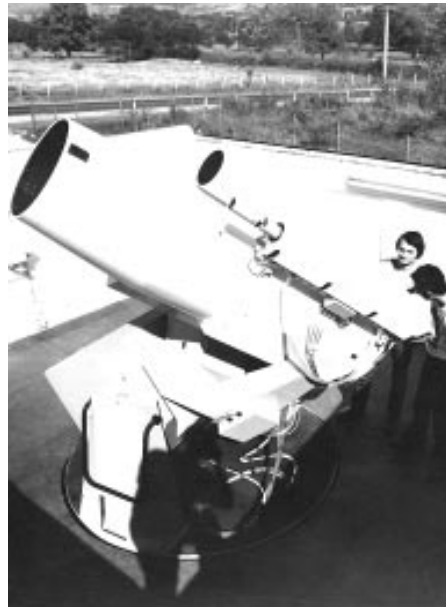
Abb. 6 Satelliten-Positionsbestimmung mit dem Gerät SBG von ZEISS/Jena und einem Laser-Radar vom ZIPE auf der Station Santiago de Cuba
