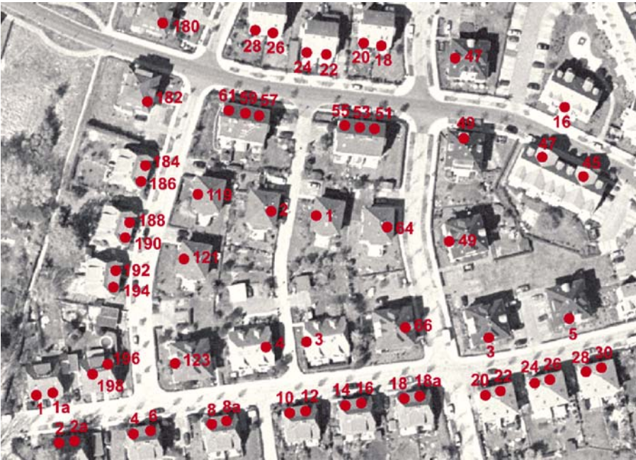
Abb. 1: Digitales Orthophoto (DOP020-C als Graustufen-darstellung) und Georeferenzierte Adresse
