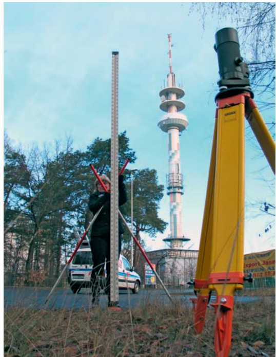
Bild 4: Klassisches Feinnivellement am Funkturm Cottbus
